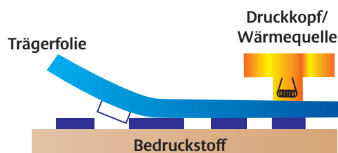
Grundprinzip des Thermotransfers
